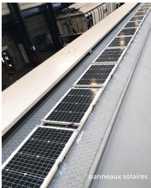
L'énergie nécessaire au fonctionnement des systèmes embarqués est fournie par des panneaux solaires situés sur la citerne du wagon.
