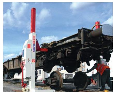
Installées en quelques minutes, elles prennent très peu de place et il est possible de connecter simultanément jusqu'à 32 colonnes entièrement synchronisées. Chaque colonne est équipée d'un panneau de contrôle multifonctionnel.
