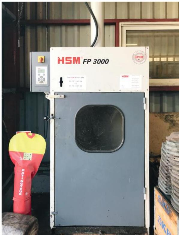
Les ateliers ont procédé au remplacement des bennes en plastique par l'installation d'une presse à fûts métalliques dont les principaux objectifs environnementaux sont les suivants :
