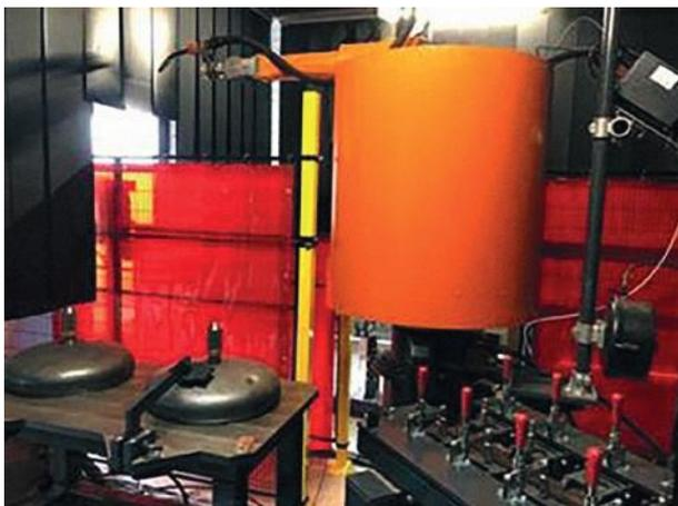
Il a donc été décidé de fabriquer ces réservoirs en interne sur le site d'Inveho UAB, en utilisant une installation de soudage robotisée.
