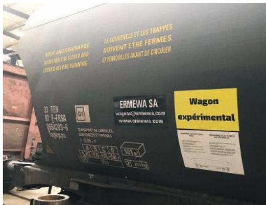
Ce véhicule est équipé de nombreux capteurs fournis par Cimes, dont le but est notamment d'optimiser la maintenance des bogies. Ces capteurs communiquent avec un système d'IA embarqué qui mesure, enregistre et transmet toutes les informations recueillies, lesquelles sont ensuite analysées par nos équipes techniques de R&D.
